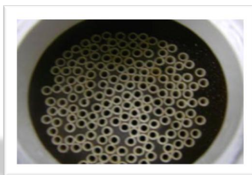
Fig. 3.1(b) Hollow fibre membranes inside the module
